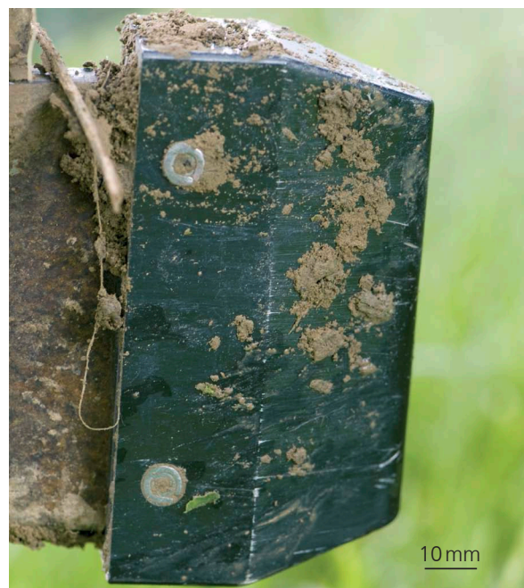
1 DLC-beschichtetes Schneidwerkzeug unmittelbar nach dem Einsatz.
